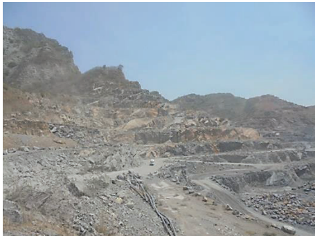
รูปที่ 2-2: การทำเหมืองแบบชั้นบันได
